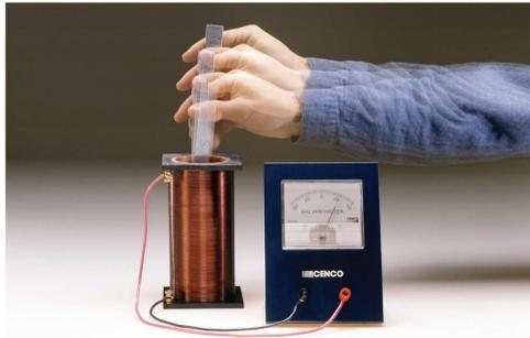
Figura 11-8: Demonstração de fem induzida, quando o imã é aproximado ou afastado da bobina, uma fem é induzida na bobina, como mostrado pela deflexão do Galvanômetro.
